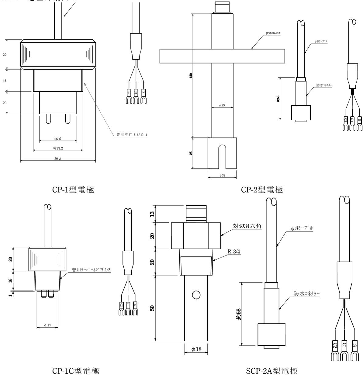
図3-1電極寸法図
