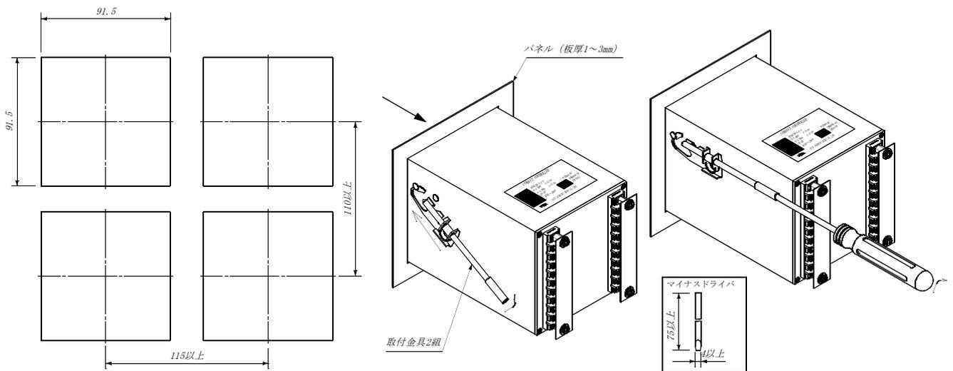
図5-1パネルカット及び計器の取り付け
