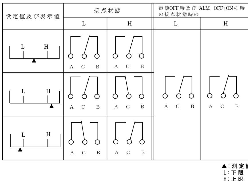
図6-3接点構成図
